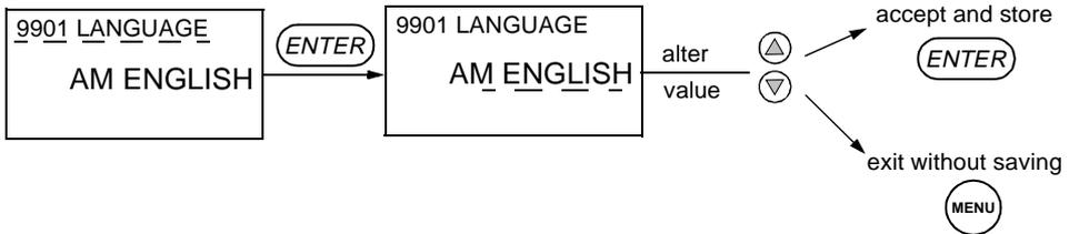
**Note! In the parameter set mode, the cursors blink when the parameter value is altered.**
